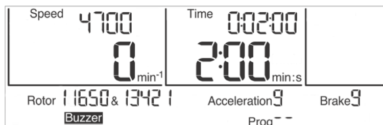
Abb. 20: Das akustische Signal "Buzzer" ist aktiviert
