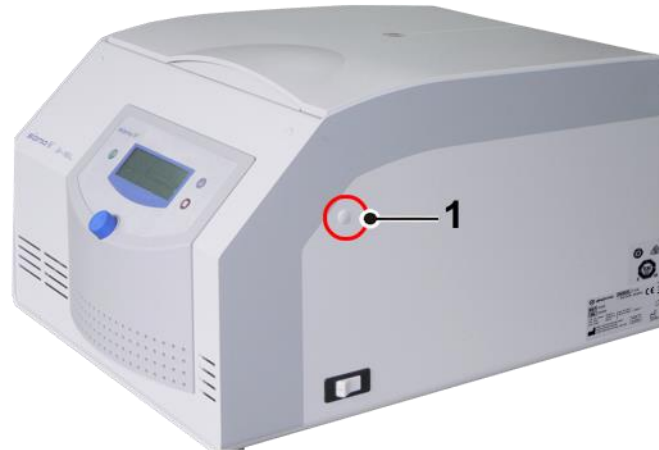
Abb. 27: Position der Öffnung für die Notentriegelung
