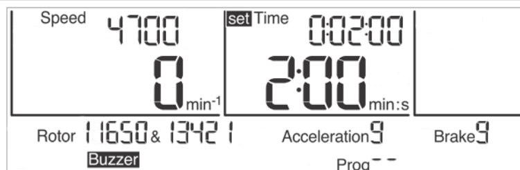
Abb. 13: Einstellen der Laufzeit, hier in der Zeiteinheit "min:s"
