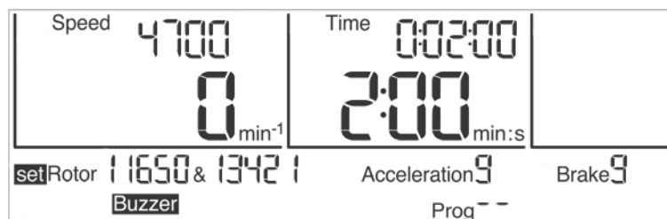
Abb. 17: Auswählen des Rotors bzw. der Rotor-Becher-Kombination
