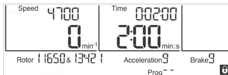
Abb. 24: Symbol "Vorhängeschloss" bei aktivierter Eingabesperre
