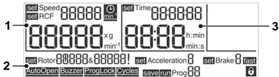
Abb. 11: Display der Steuerung "Spincontrol L"
