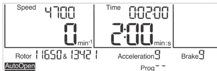
Abb. 19: Die automatische Deckelöffnung "Auto Open" ist aktiviert
