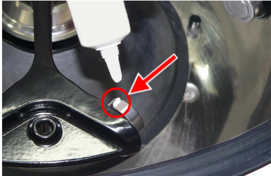
Abb. 28: ausreichende Menge Tragbolzenfett für einen Bolzen
