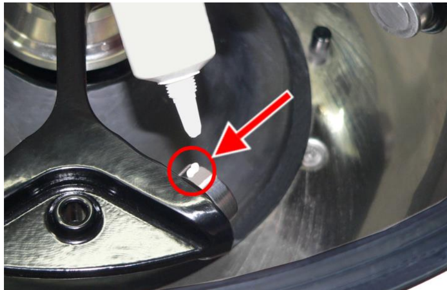
Abb. 22: ausreichende Menge Tragbolzenfett für einen Bolzen
