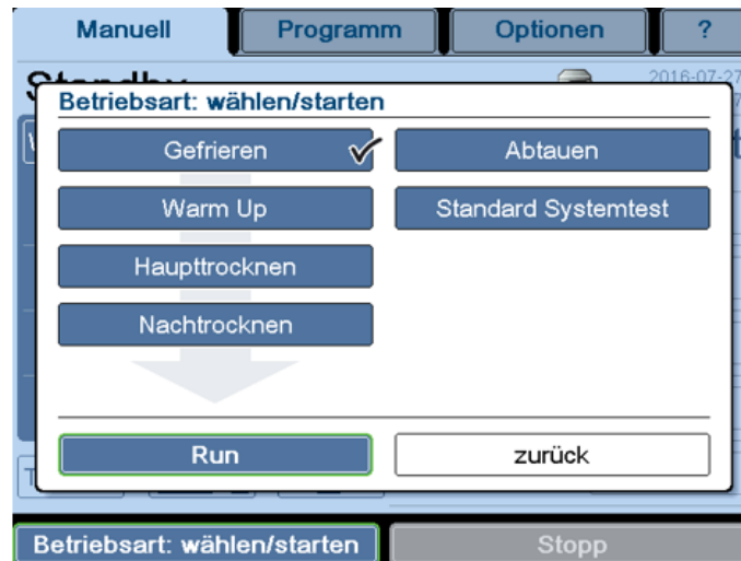
Abb. 29: Dialogfenster "Betriebsart wählen / starten" (Anzeige variiert je nach Ausstattung der Gefriertrocknungsanlage)
