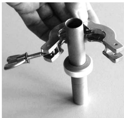
Abb. 74: Ansetzen des Spannrings
