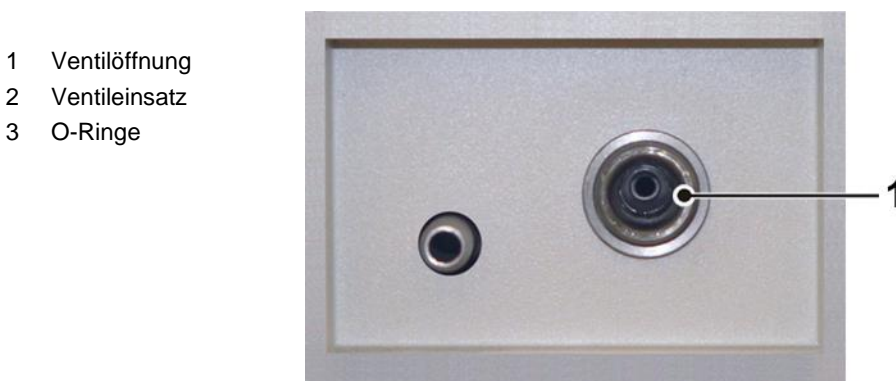
Abb. 77: Ventilöffnung und Ventileinsatz mit O-Ringen (Beispielabbildung, variiert je nach Anlagentyp)
