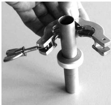
Abb. 54: Ansetzen des Spannrings
