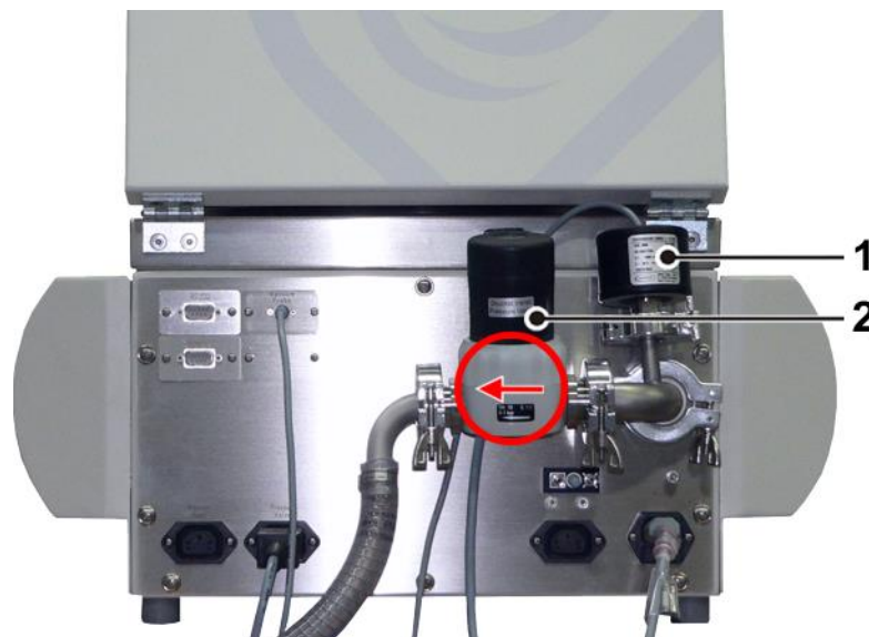
Abb. 9: Anschluss von Drucksteuerventil und Vakuummesssonde
