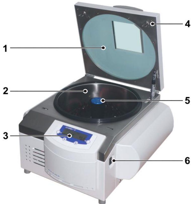
Abb. 64: Übersicht über den Rotations-Vakuum-Konzentrator
