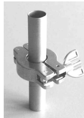
Abb. 53: Festziehen des Spannrings
