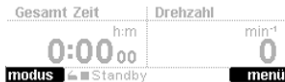
Abb. 20: Anzeige der Belegung der Funktionstasten; hier links die Funktion "modus", rechts die Funktion "menu"
