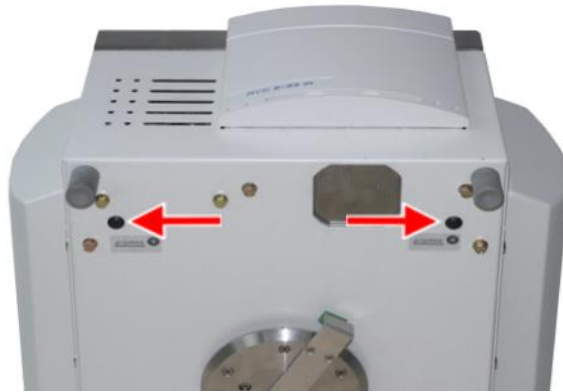
Abb. 47: Positionen der Schrauben der Notentriegelung
