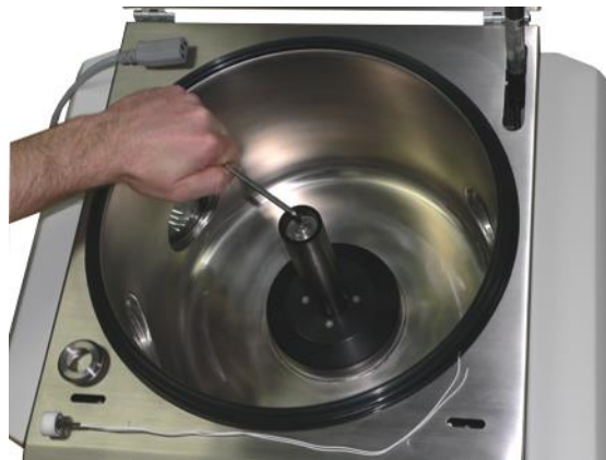
Abb. 59: Lösen der Rotoraufnahme inkl. Magnetkupplung
