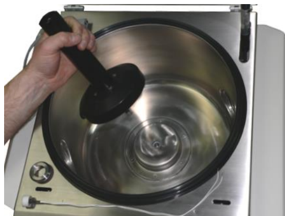
Abb. 60: Entnehmen der Rotoraufnahme inkl. Magnetkupplung
