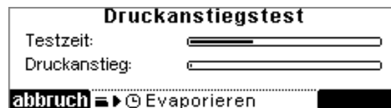
Abb. 40: Grafische Darstellung des Druckanstiegstests
