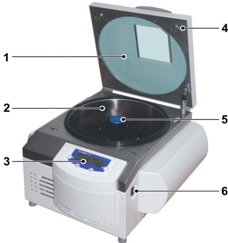
Abb. 1: Übersicht über den Rotations-Vakuum-Konzentrators
