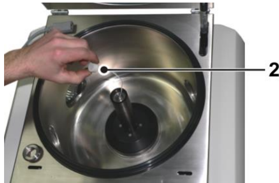
Abb. 58: Entnehmen der Temperatur-Messelektronik
