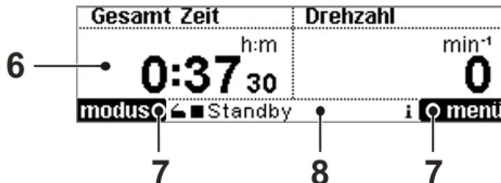
Abb. 22: Gliederung des Displays der CDplus-Steuerung
