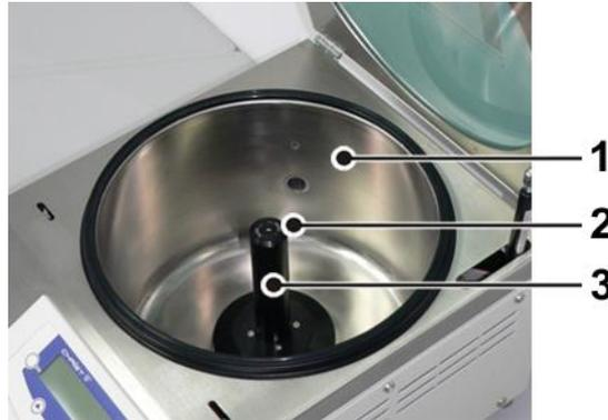
Abb. 55: Rotorkammer mit Rotoraufnahme
