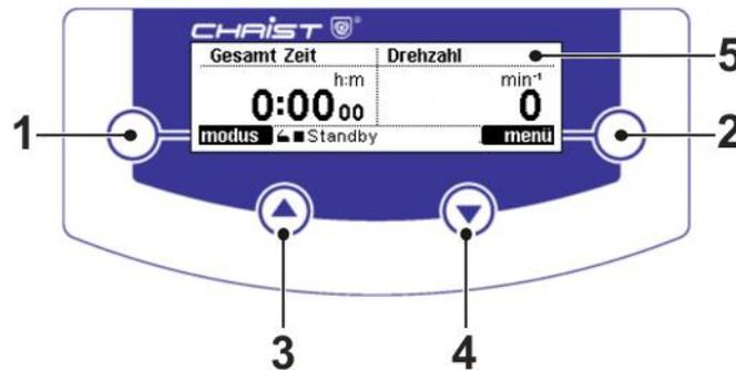
Abb. 20: Bedienoberfläche der CDplus-Steuerung
