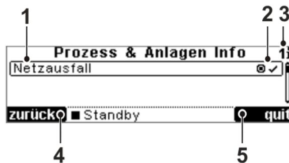
Abb. 42: Aufbau des Menüs "Prozess- und Anlagen Info"
