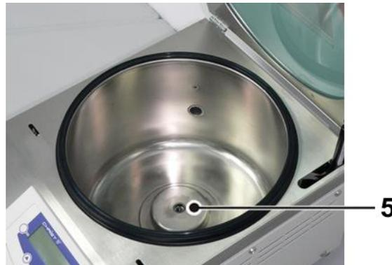
Abb. 58: Öffnung am Boden der Rotorkammer (ohne Rotoraufnahme)
