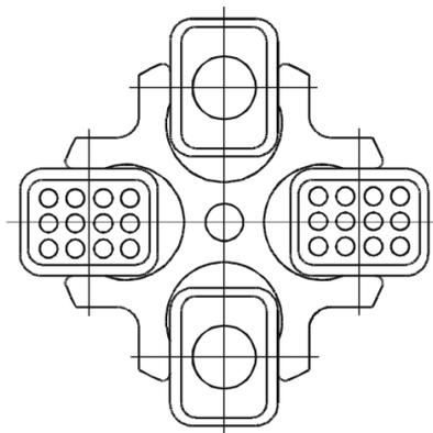
Abb. 15: Zulässige Beladung eines Ausschwingrotors mit unterschiedlichen Gefäßgrößen
