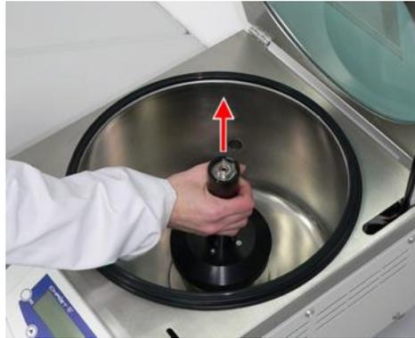
Abb. 57: Abziehen der Rotoraufnahme
