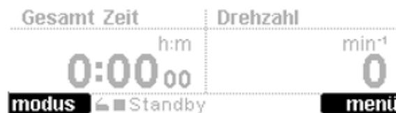
Abb. 21: Anzeige der Belegung der Funktionstasten; hier links die Funktion "modus", rechts die Funktion "menu"
