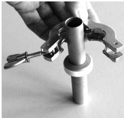
Abb. 53: Ansetzen des Spannrings
