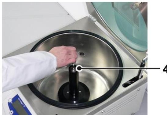
Abb. 56: Lösen der Innensechskantschraube
