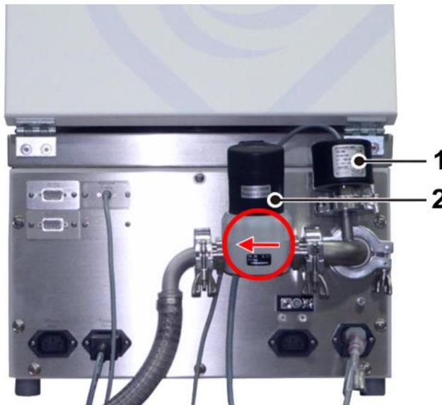
Abb. 10: Anschluss von Drucksteuerventil und Vakuummesssonde
