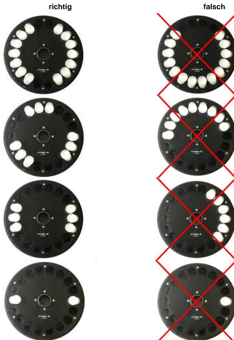
Abb. 14: symmetrische Beladung von Winkelrotoren
