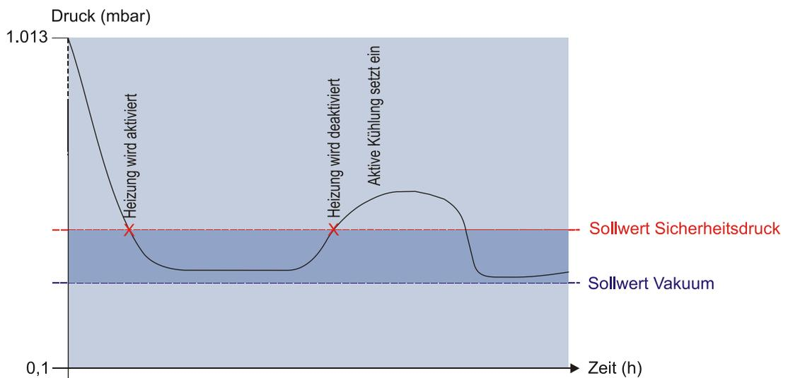
Abb. 62: Grafische Darstellung der Sicherheitsdruck-Funktion
