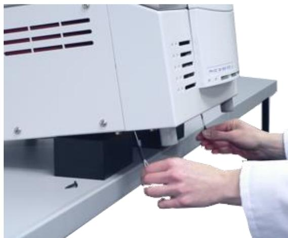
Abb. 50: Entriegelung beider Deckelschlösser
