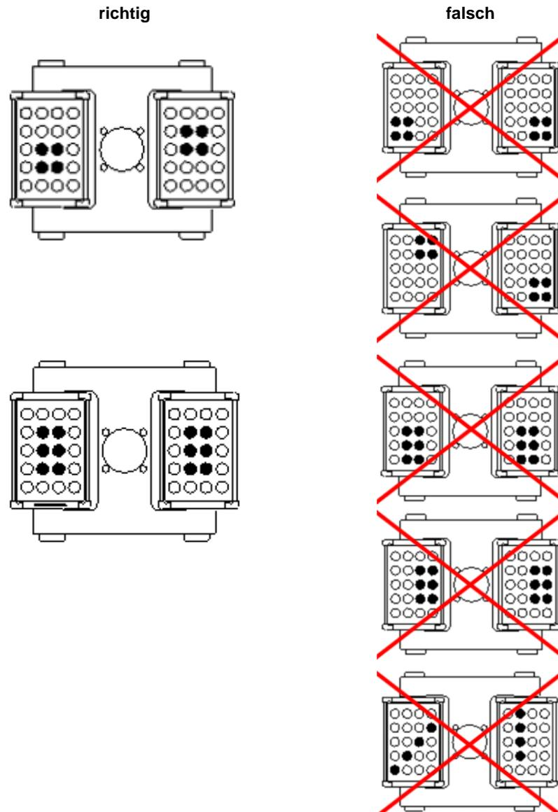
Abb. 16: zulässige Beladung von Ausschwingrotoren bei geringer Kapazität
