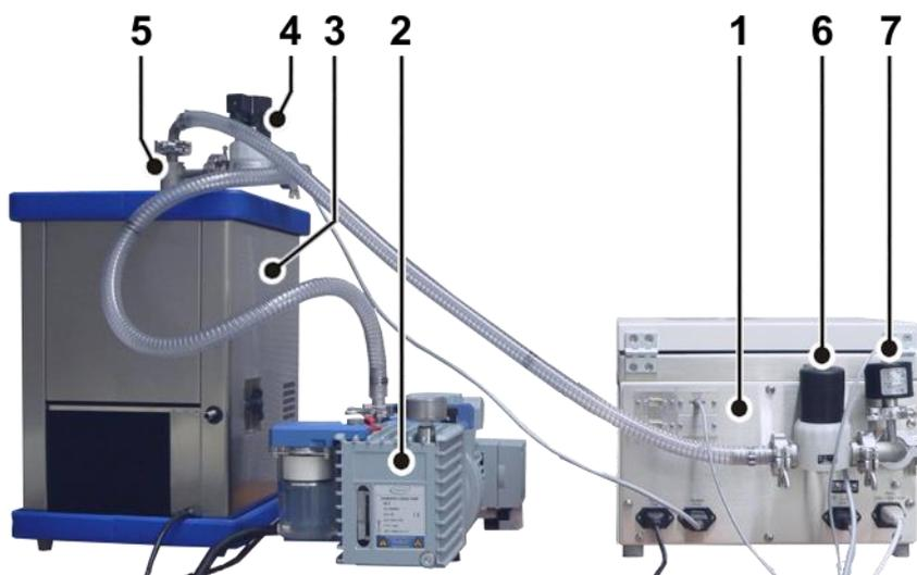
Abb. 13: Kombination der RVC mit Vakuumpumpe und Kühlfalle
